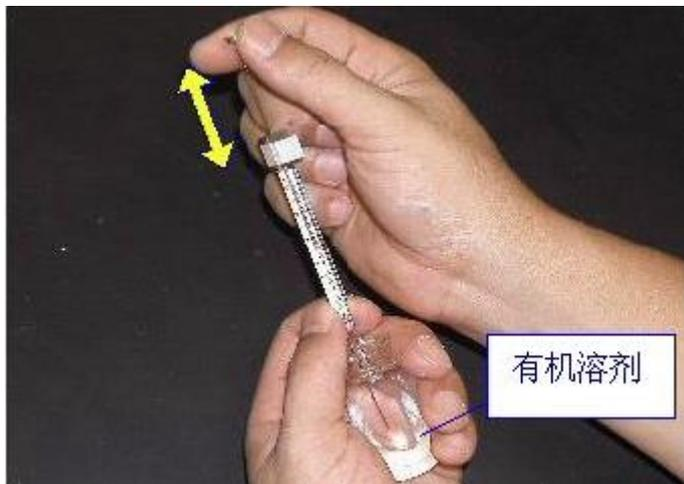
❖ 将进样针针头浸入丙酮内，然后来回拉动针杆，直到针杆可以灵活顺畅移动，如有细小颗粒洗出，请更换丙酮后再次清洗。
