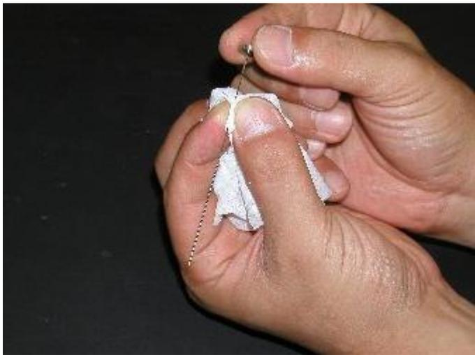
❖ 确认针杆的灵活性，针杆拉到满刻度，将针杆推回，如很紧或时紧时松时，需清洗针杆。
