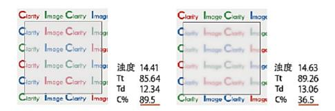
示例 3 很好的说明:雾度(浊度)值相同的两块玻璃片,放在本体上呈现的 清晰度差异很大。实际上清晰度和雾度是两个概念,测量模式和方法不同,所使 用的仪器结构和原理也是不同,二者真的是没有一点关系。
