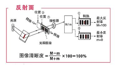
示例 4 是以反射法为例,通过光源的成像理论,仪器内置光栅,通过定距调整光栅位置,可测量出光源在样品上的像的最大反射率和最小反射率,通过换算得到清晰度值 C%,C%值越大,图像越清晰,失真度越小。
