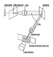
综述:清晰度计是仪器光源在透明和不透明样品上所成图像的失真度来衡量 样品的清晰度情况!
